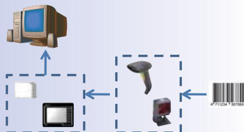
Для модернизации промышленного процесса автоматизации производства каждой единице продукции присваивается штрих-код. Панель оператора серии EU200/EC200 можно подключить к сканеру штрих-кода и через COM-порт сохранить отсканированные данные на карту памяти SD.
