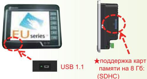
USB-порт на передней панели - это простой и удобный для пользователя способ загрузки программ в панель оператора. Отсутствие необходимости в демонтаже оборудования для установки необходимых соединений значительно экономит время. Плотная USB-крышка предохраняет от попадания пыли и посторонних предметов. Возможность подключения карты памяти SD и USB-накопителя для сохранения файлов, команд и т.д.
